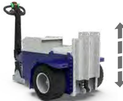
GANCHO HIDRÁULICO PARA ELEVACIÓN
